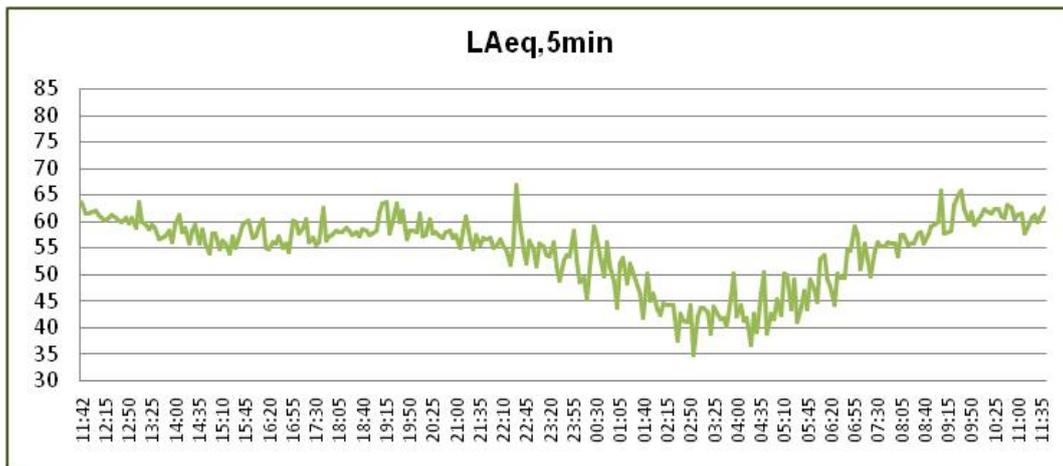
Tal y como se observa de la imagen anterior, la huella sonora muestra unos niveles sonoros variables en un rango de entre 55-65 dBA para el período diurno y de entre 35-55 dBA para el período nocturno, debido a las fluctuaciones del tráfico rodado. No obstante, cabe destacar que el centro de salud no permanece abierto durante el período nocturno puesto que no hay camas en el mismo y no se producen pernотaciones.
