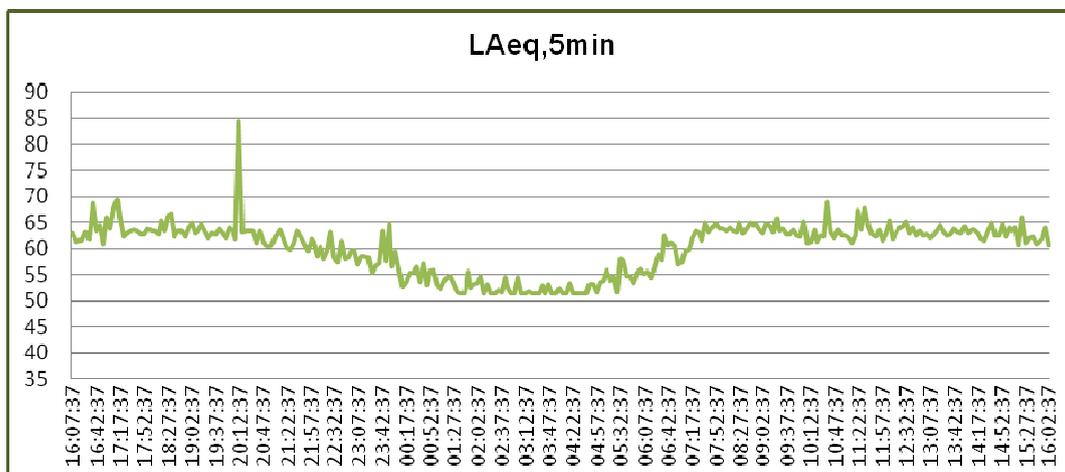
En cuanto a la medición realizada en la vivienda de la C/ Lauri Volpi, los resultados muestran un nivel equivalente en el período diurno de LAeq,D=60,3 dBA y para el período nocturno LAeq,N=54,0 dBA. En ambos períodos se supera el Objetivo de Calidad Acústica pero en ningún caso excede los 10 dBA.
